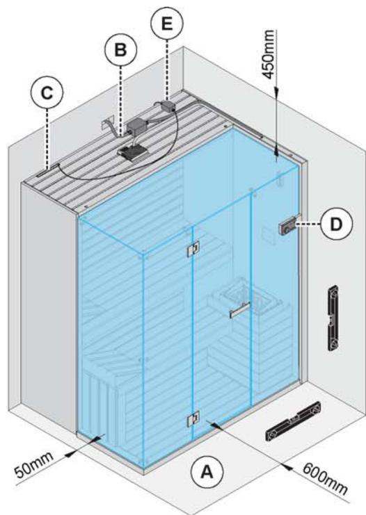
Spazio limitrofo alla sauna per un facile montaggio, al di sotto di tale misura contattare l'azienda.
