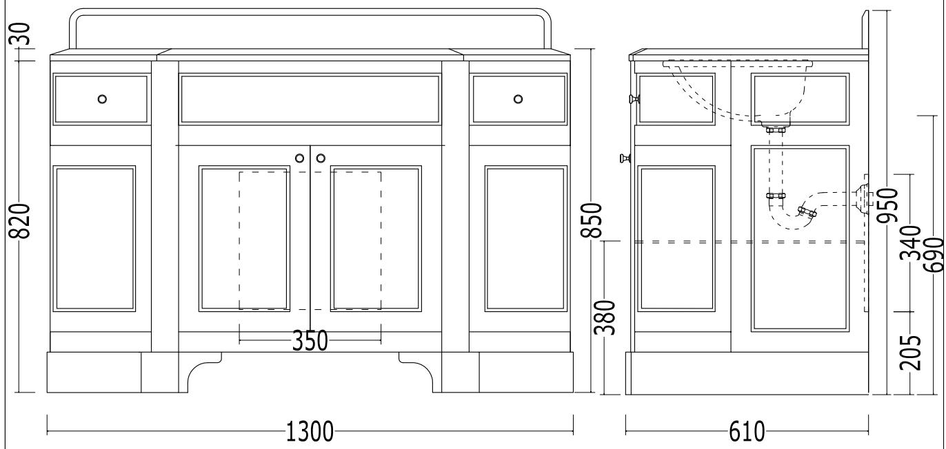
N.B. - Tutte le misure sono in millimetri / All measurements are in millimetres
