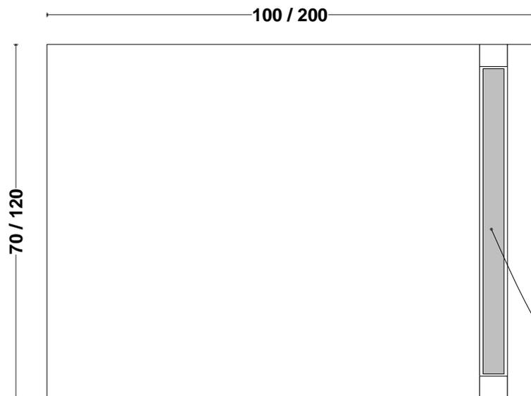
Per rivestimenti non rigidi ( mosaico, gomma, resine ...) e per il gres porcellanato con spessore inferiore a 5.5 mm effettuare sul piatto UNICO una rasatura fibrorinforzata di spessore min. 10 mm o incollare una superficie rigida (lastra di alucobond , piastrelle ...) per poi procedere il rivestimento.
