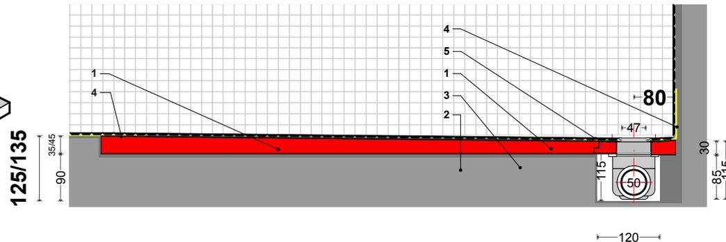
**Per rivestimenti non rigidi (mosaico, gomma, resine ...) piatto UNICO va predisposto con una rasate fibrorinforzata sp.min 10mm sulla sua superficie o incollata una superficie portante (lastra di alucobond, piastrelle...)per poi procedere con la finitura.**
