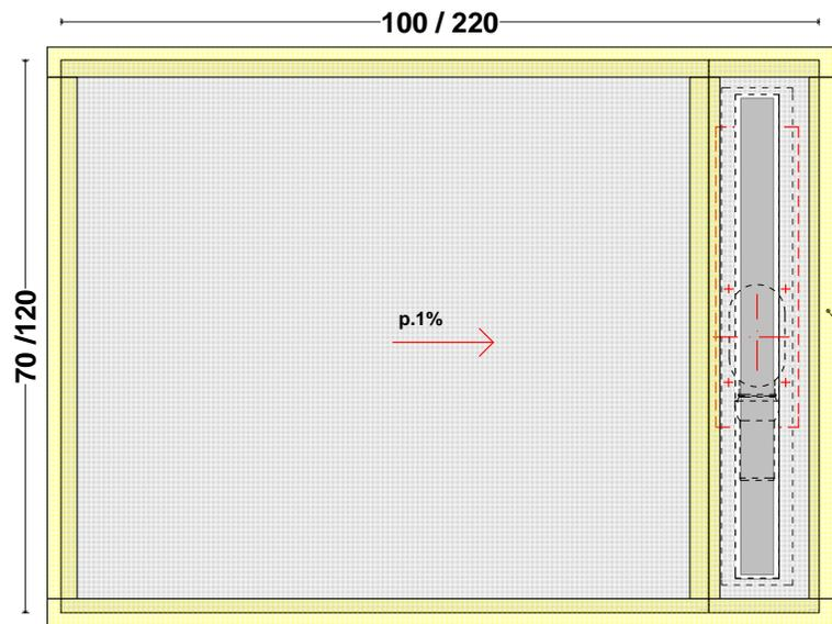
L'incollaggio a pavimento va effettuato su tutta la superficie con collante MAPEI KERALASTIC o con altro collante di uguali caratteristiche tecniche
